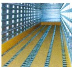
Sistemas de Roletes Pneumáticos para transporte de carga paletizada (fixado ao piso do baú).
