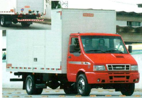
**FURGÕES DE ALUMÍNIO:** Para todos os tipos de chassis, em diversas versões e em formato de **KITS** para montadores.
