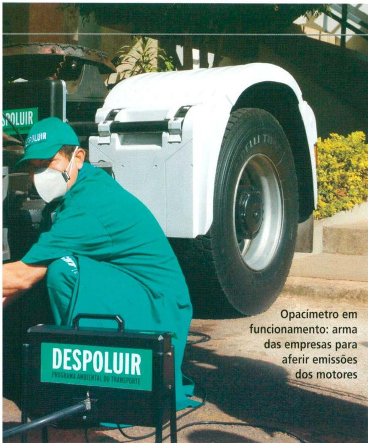
Opacímetro em funcionamento: arma das empresas para aferir emissões dos motores
