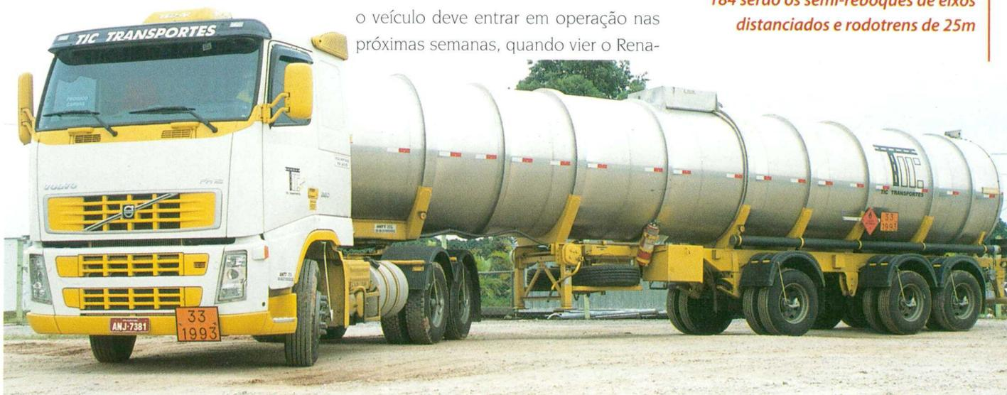
que utiliza o máximo de carga por eixo, chegando a um total de 48,5 toneladas, que antes estava limitado a 45", informa a engenharia da Randon.
