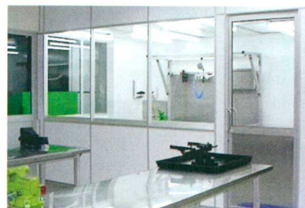
Clean room para reparo de injetores Common Rail.
