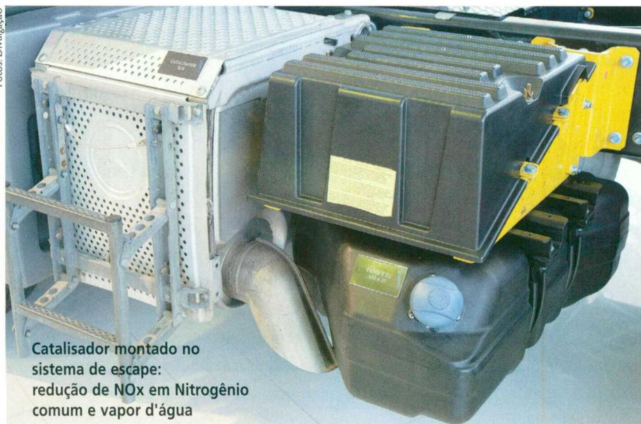
**Catalisador montado no sistema de escape: redução de NOx em Nitrogênio comum e vapor d'água**
