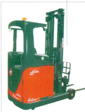
Outra novidade foi a empilhadeira retrátil R 17 BR, modelo Active, com capacidade para 1.700 Kg. Equipada com novo painel, mais acessível para o operador, o modelo permite regulação da tração e elevação através de software. Por se fabricada no Brasil, a R 17 BR pode ser financiada através do
