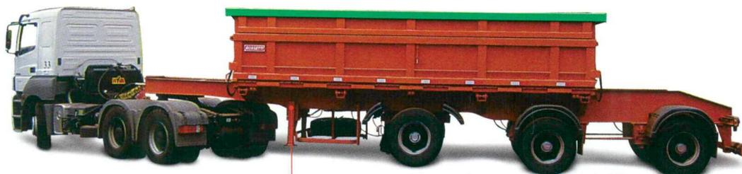
Semirreboque Basculamento Lateral 3D
