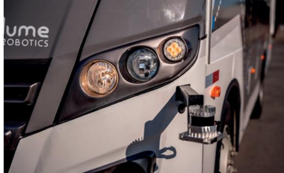
Santo (FAPES) e conta com um sistema robótico avançado para trafegar de modo autônomo em situações específicas, como circuitos fechados de baixa velocidade.
