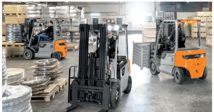
de capacidade de carga: para 2 ou 2,5 toneladas. A elevação do mastro pode alcançar até 6,50 metros de altura e a velocidade máxima é de 15 km/h. A tração traseira combinada com o motor de acionamento trifásico encapsulado de 80 Volts garante o máximo de eficiência energética, inclusive em operações severas.
